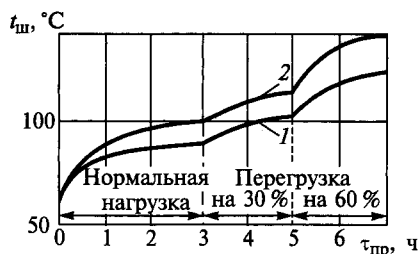
Рис. 11.7. Зависимость температуры деталей шины t_{ш} от времени пробега \tau_{пр} при различных нагрузках:
